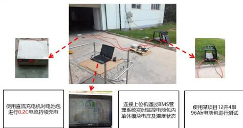
图 11 台架实验照片
